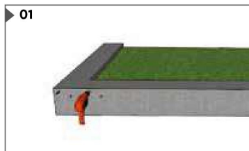
1. วัดระยะและเจาะรูวัสดุพื้นผิวตามระยะ เพื่อเตรียมยึดสล็อกอลูมิเนียม
