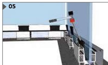
05 วางกระจกลงบนบล็อก และดอกสลิมนพลาสติก EPDM ในร่องด้านในเพื่อปรับระดับและยึด กระจกให้แน่น
