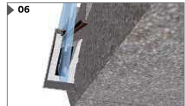
6. ใส่ฝ้าครอบอลูมิเนียมด้านใน โดยใช้เทปกาวสองหน้าติด
