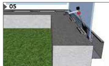
05 วางกระจกลงบนบล็อก และตอกลิ่มพลาสติก EPDM ในร่องด้านในเพื่อปรับระดับและยึดกระจกให้แน่น
