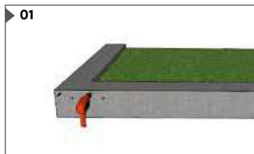
01 วัดระยะและเจาะรูวัสดุพื้นผิวตามระยะ เพื่อเตรียมยึดบล็อกอลูมิเนียม
