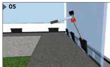
5. วางกระจกลงบนสล็อก และตอกลิ่มพลาสติก EPDM ในร่องด้านในเพื่อปรับระดับและยึดกระจกให้แน่น
