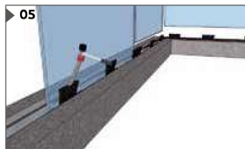
05 วางกระจกลงบนบล็อก และตอกสั้มพลาสติก EPDM ในร่องด้านในเพื่อปรับระดับและยึดกระจกให้แน่น
