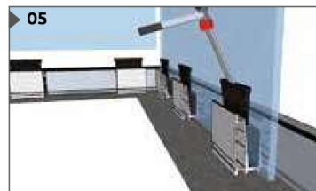
05. วางกระจกลงบนบล็อก และต่อกลีมนพลาสติก EPDM ในร่องด้านในเพื่อปรับระดับและยึดกระจกให้แน่น
