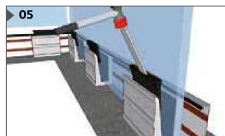
5. วางกระจกลงบนบล็อก และตอกสัมนพลาสติก EPDM ในร่องด้านในเพื่อปรับระดับและยึดกระจกให้แน่น ใส่สลีปและน็อตเพื่อล็อกสัมน EPDM
