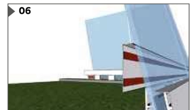
06 ใส่ฝาครอบอลูมิเนียมด้านใน
