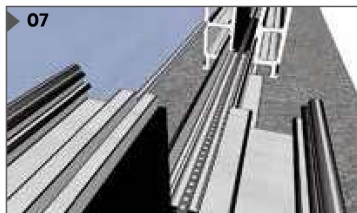
07. ใส่ไฟ LED ลงบนราง
